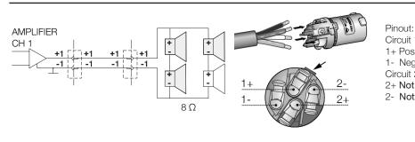
NL4 input/output wiring
